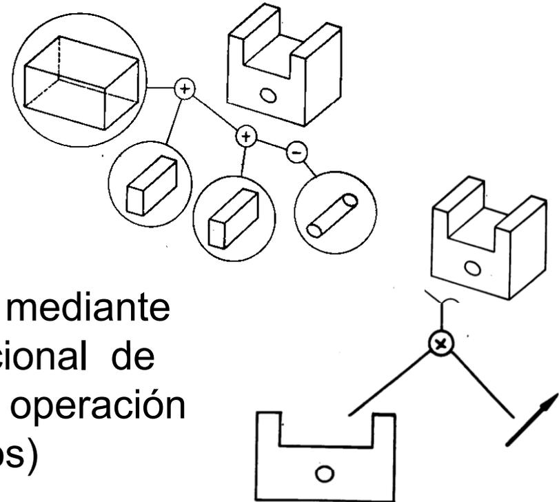
2 También se crean primitivas mediante bocetado paramétrico/variacional de perfiles planos con posterior operación de extrusión (perfiles barridos)
