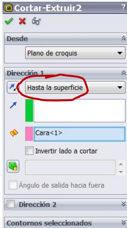
El "cortar-extruir" hasta la superficie inferior, elimina el material deseado
