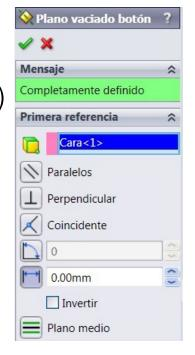
Cree un plano sobre la cara inferior (Datum 11) para crear el perfil, porque simplificará la extrusión
