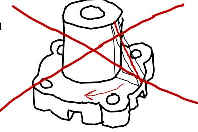
Analizando la geometría con detenimiento, se observa que al añadir el nervio se obtendría una geometría no válida
