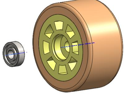
✓ Haga la cara lateral del rodamiento coincidente con la interior del alojamiento de la llanta
