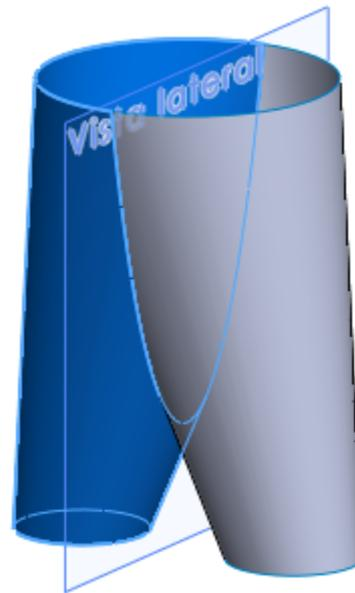
Puede coser ambas superficies, dar espesor al resultado y convertirlo en chapa
