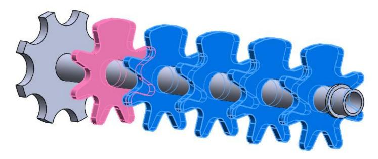
Por tanto, el resto de discos se tendrían que modelar sin aplicar patrón, y repitiendo completo el proceso empleado para el disco A
