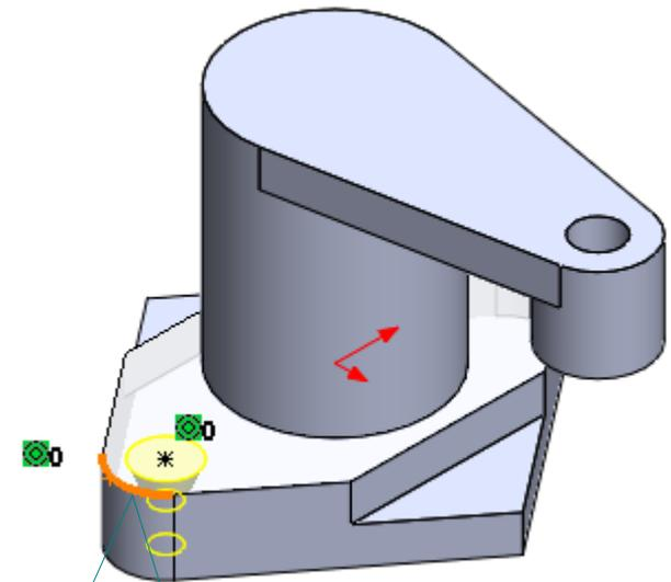
Para fijar la posición, mueva el cursor a través del borde del brazo, para que se muestre el centro del arco
