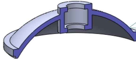
Se puede obtener la cáscara por revolución de un perfil de pequeño espesor
